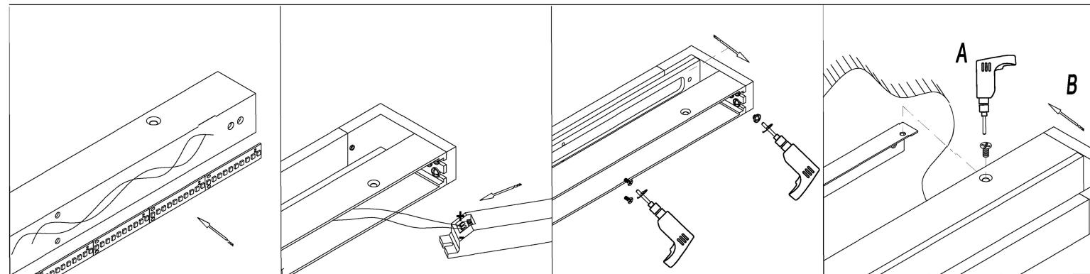
Add the glue to the lamp body / Fügen Sie den Kleber zum Lampenkörper hinzu.
