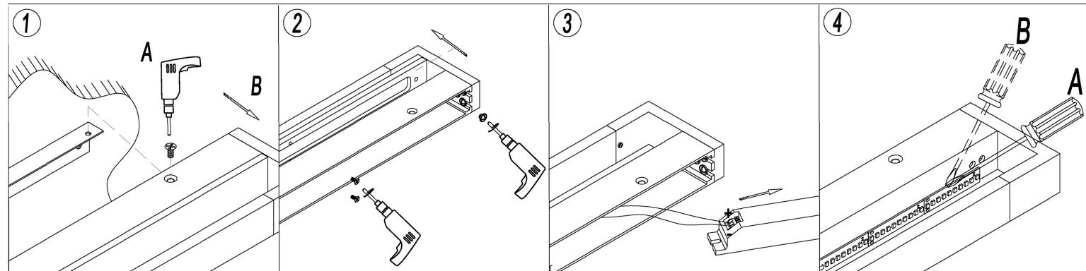
Remove the mounting plate / Entfernen Sie die Befestigungsplatte
