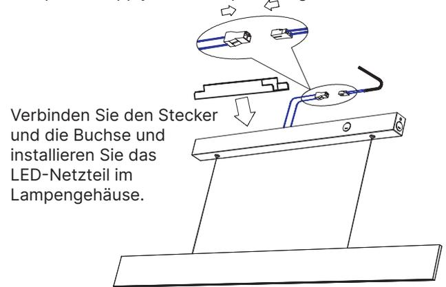
Verbinden Sie den Stecker und die Buchse und installieren Sie das LED-Netzteil im Lampengehäuse.
